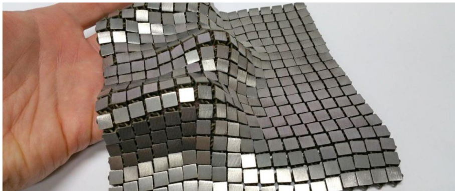
NASA đã dùng máy in 3D sản xuất áo giáp "Chain mail"
