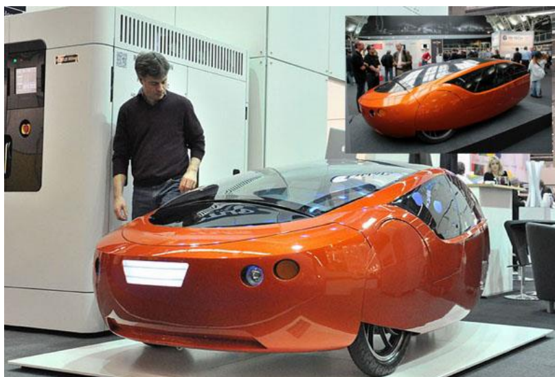
Chiếc xe ô tô Urbee đã được sản xuất toàn bộ bằng công nghệ in 3D
