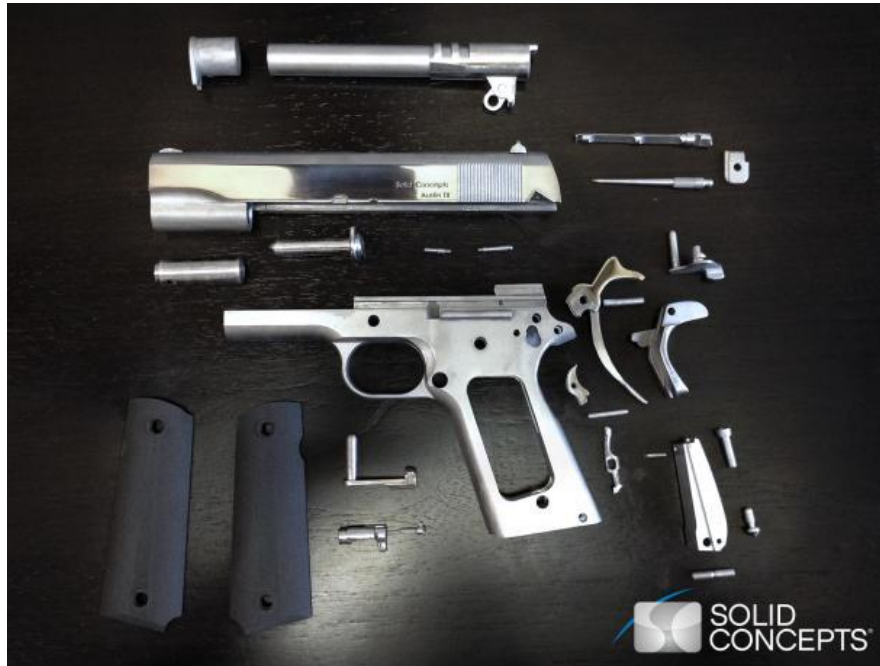
Khẩu súng bắn đạn thật được sản xuất bằng công nghệ in 3D
