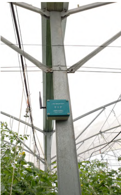
Bộ cảm biến vi khí hậu giám sát nhiệt độ, độ ẩm, ánh sáng trong nhà kính
