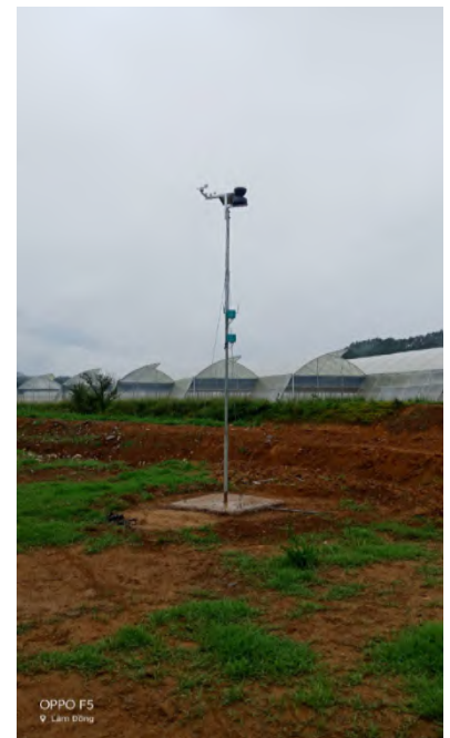
Trạm thời tiết giám sát nhiệt độ, độ ẩm, ánh sáng, mưa và gió
