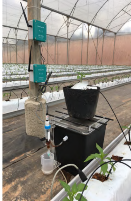
Cảm biến đo lượng nước và EC thoát ra trong canh tác nhỏ giọt giá thể
