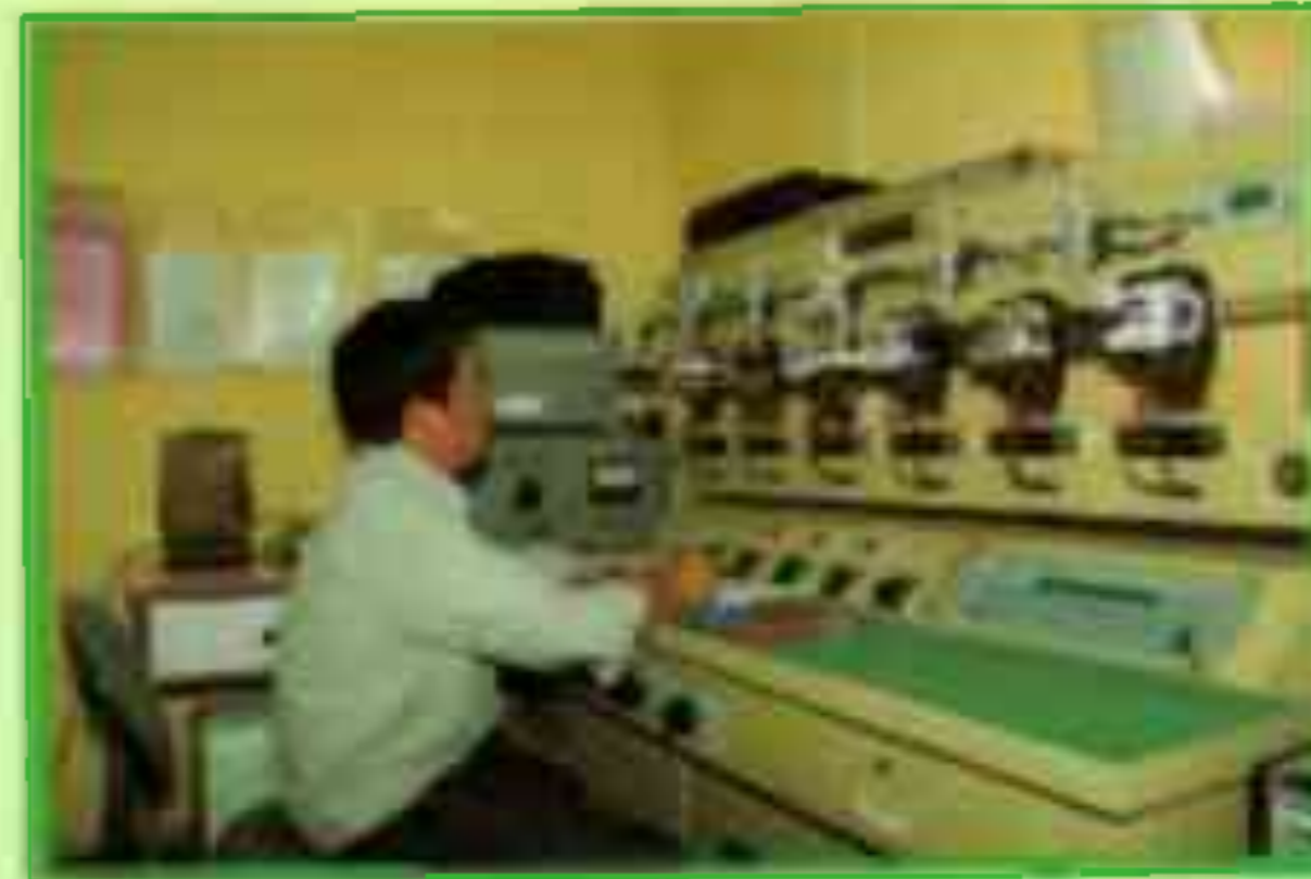
Kiểm định công tơ điện
