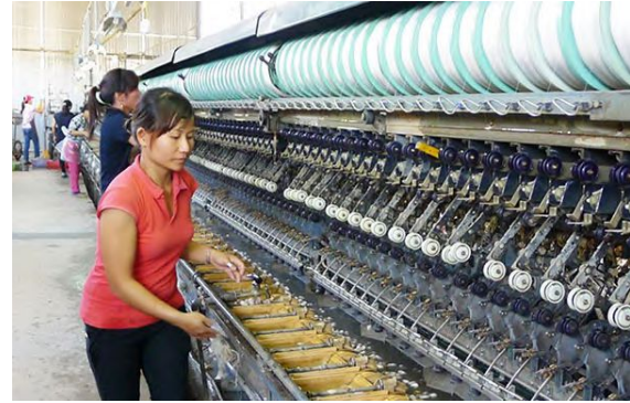
Dây chuyền ươm tơ tự động ở Cơ sở ươm tơ Phú Cường (xã Đại Lào, Tp. Bảo Lộc)
