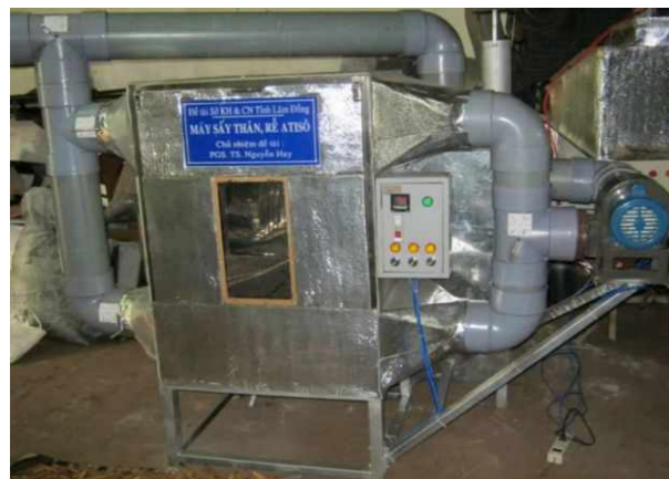
Máy sấy thân, rế atisô thái lát được chế tạo và lắp ráp hoàn chỉnh
