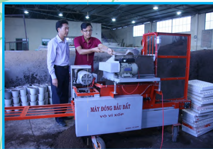
Máy đóng bầu đất vào vỏ vi xốp tại Cơ sở nghiên cứu, ứng dụng máy nông nghiệp Hồng Chương (Lạc Lâm - Đơn Dương)
