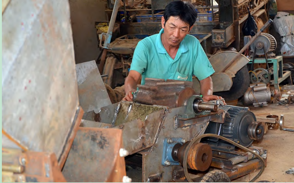
Nông dân Vũ Đình Phúc với máy chế biến phế phẩm nông nghiệp thành phân hữu cơ vi sinh thân thiện với môi trường (Ảnh: Đan Thanh)
