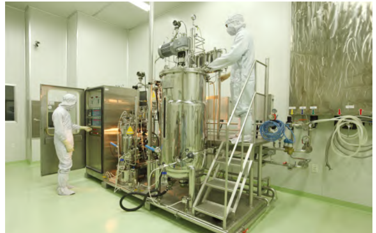
Lên men vi khuẩn Thương hàn Salmonella Typhi trong sản xuất Vắc xin Thương hàn Vi polysaccharide
