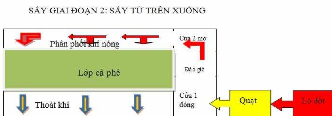
Hình 3. Mô hình công nghệ sấy đảo chiều gió giai đoạn 2
