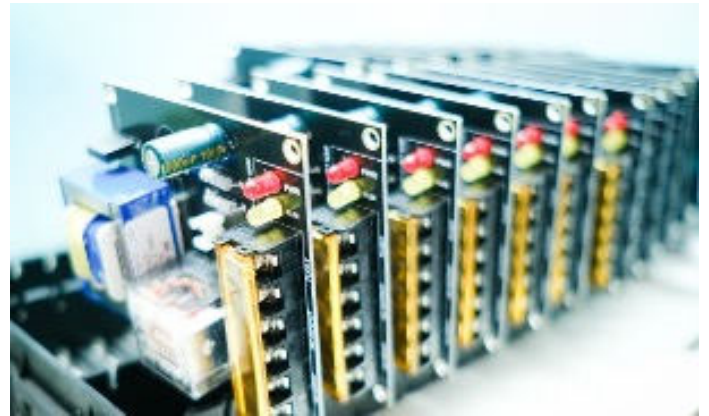
Những bản mạch điện tử của rơ le chống giật đã hoàn thiện, chờ lắp khung vỏ.
